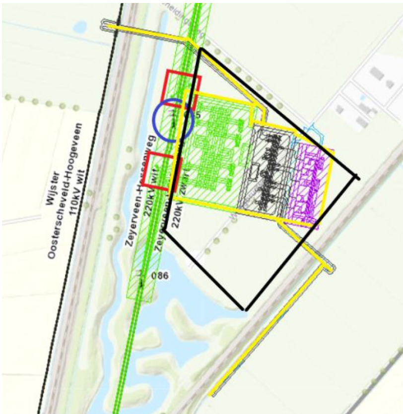
Afbeelding 3 Voorlopig vlekkenplan met in geel (omlijnd) het station en de kabelinlussingen, in de rode vierkanten de nieuw te bouwen portalen en in de blauwe cirkel de te amoveren mast 85.
