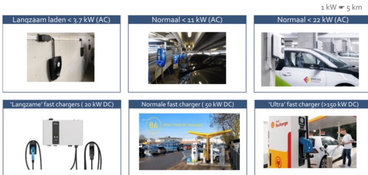
Figuur 3: Soorten laadpalen en bijbehorende vermogens
